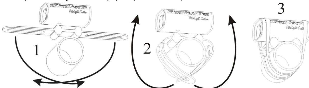
Кнопка включения фары устанавливается так, чтобы на неё было удобно нажимать большим пальцем. Наиболее удобное место для установки кнопки - зажим монетки переключения передач. «Липучку», на которую крепится кнопка, лучше клеить при комнатной температуре.
